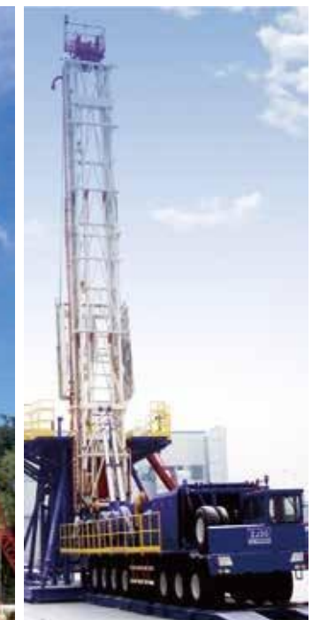
МБУ для бурения и ремонта скважин
