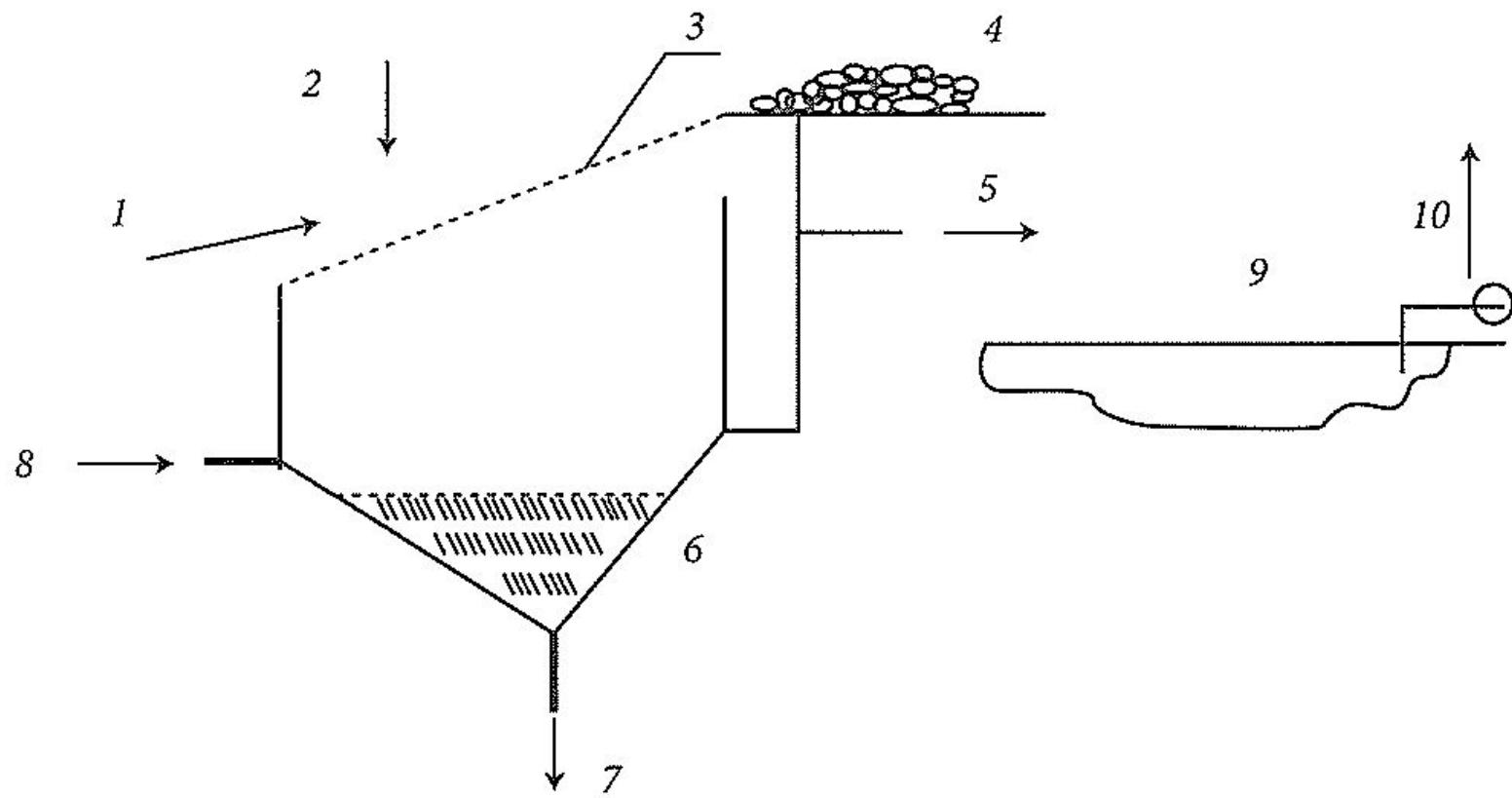
**Рис. 4.1. Схема получения черновых концентратов при скважинной гидродобыче:**
