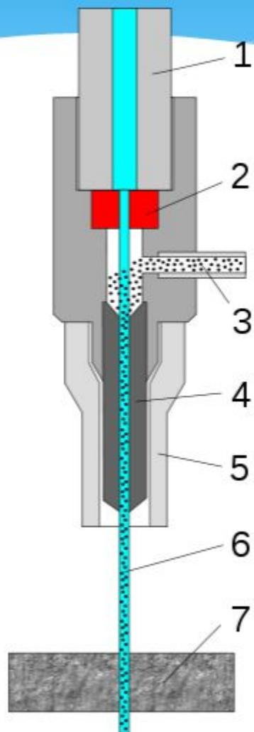
1 — подвод воды под высоким давлением, 2 — Сопло, 3 — подача абразива, 4 — смеситель, 5 — кожух, 6 — режущая струя, 7 — разрезаемый материал.
