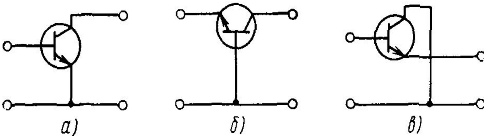
Схемы включения транзистора с общим эмиттером (а), с общей базой (б) и с общим коллектором (в).
