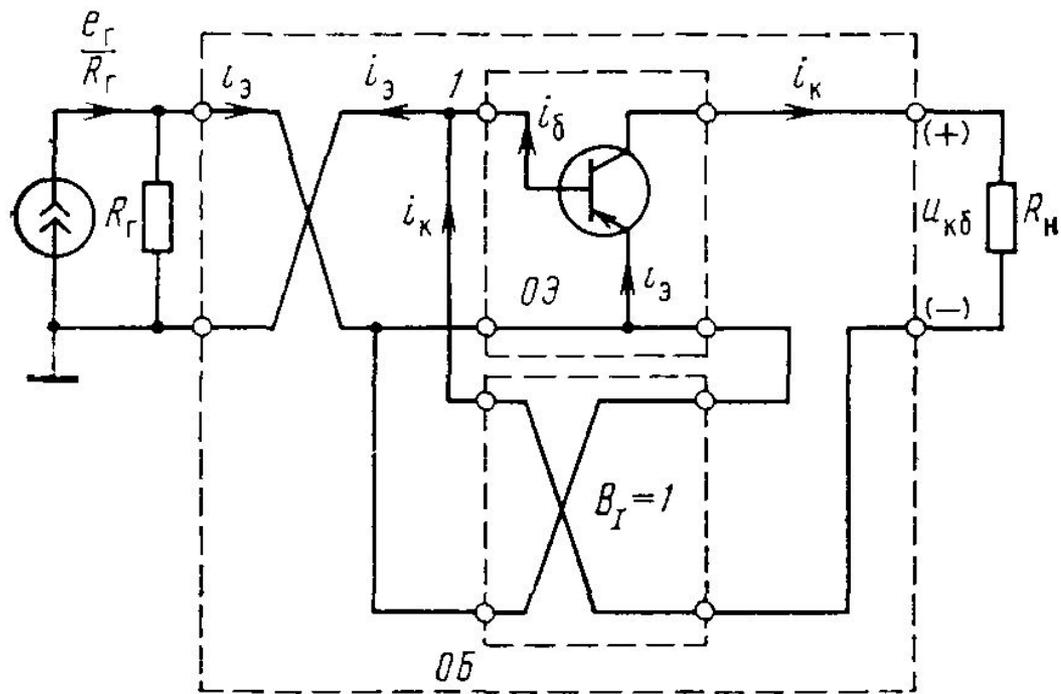
Представление каскада с общей базой в виде каскада с общим эмиттером, охваченного 100% параллельной ОС по току
