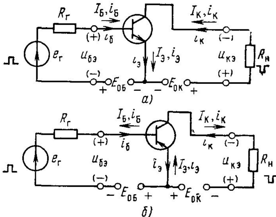
Каскад с общим эмиттером на транзисторах *n-p-n* типа(а) и *p-n-p* типа(б).
