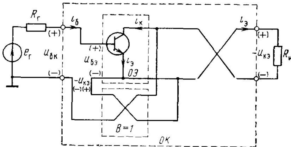
Представление каскада с общим коллектором в виде каскада с общим эмиттером, охваченного 100% последовательной ОС по напряжению
