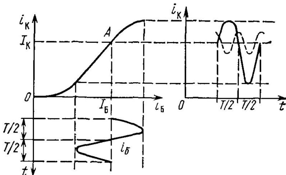
Характер нелинейных искажений при возбуждении каскада с общим эмиттером гармоническим током
