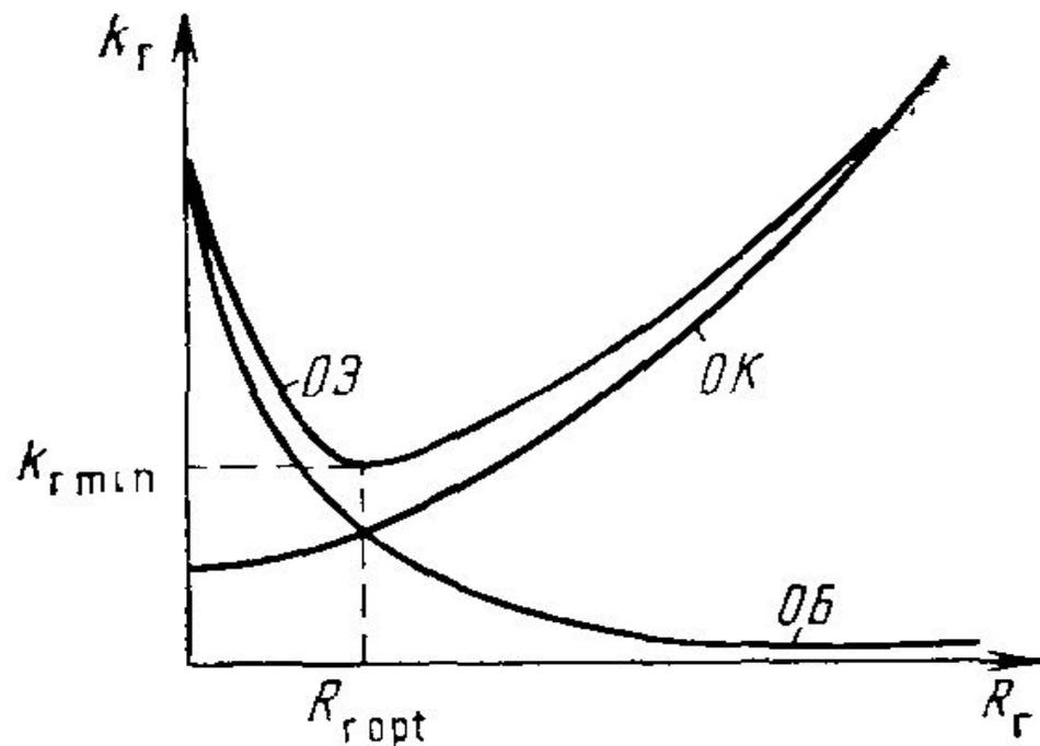
Зависимость коэффициента гармоник от сопротивления источника сигнала
