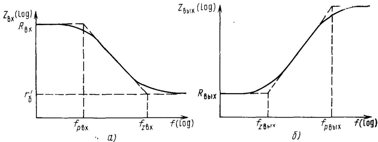
Частотные характеристики входного (а) и выходного (б) сопротивлений каскада с общим коллектором
