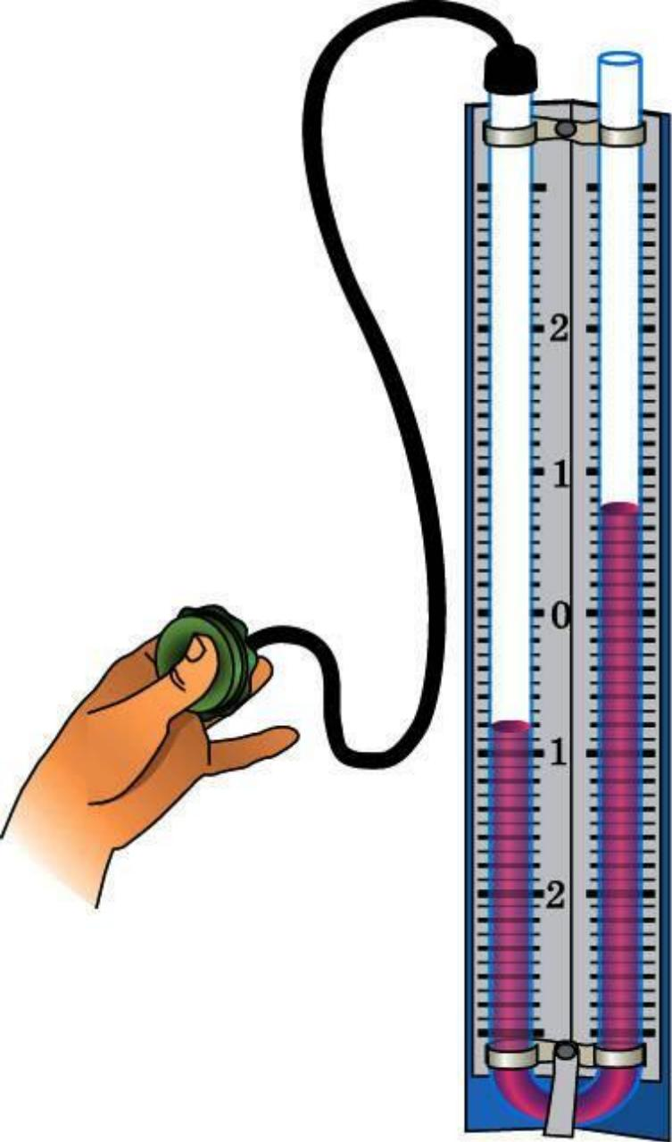
Принцип действия жидкостного манометра
