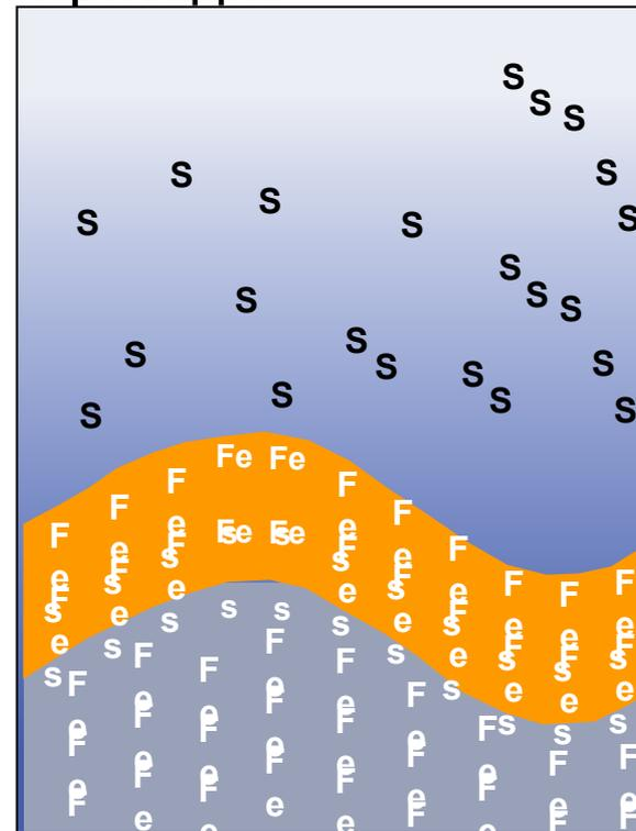
Образование пленки при реакции присадки с поверхностью металла
