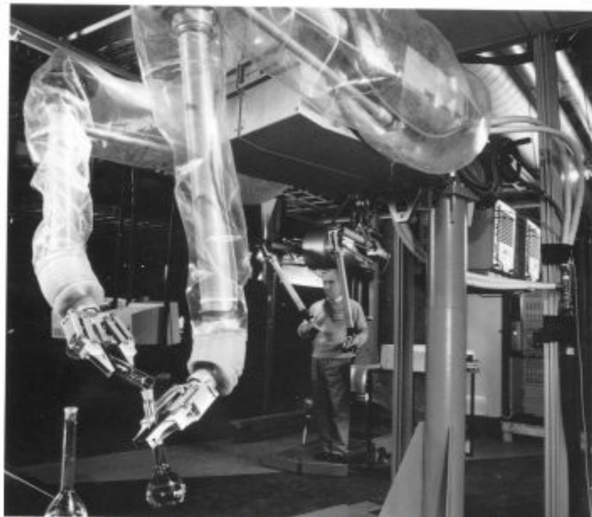
Рис.1.4. Копіюючий маніпулятор Маскот фірми "Телеробот"(Італія).
