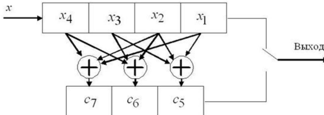
Применение любого кода предполагает реализацию не только кодирования, но и декодирования. Декодирование систематического линейного блочного кода могло бы заключаться в простом отбрасывании проверочных символов, но это не обеспечивало бы обнаружения и исправления ошибок.
