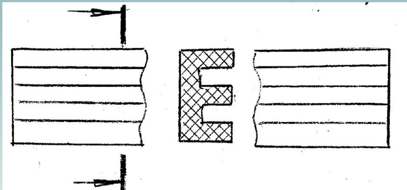
4. Во всех остальных случаях положение секущей плоскости обозначают разомкнутой линией, направление взгляда указывают стрелками с буквенным обозначением.
