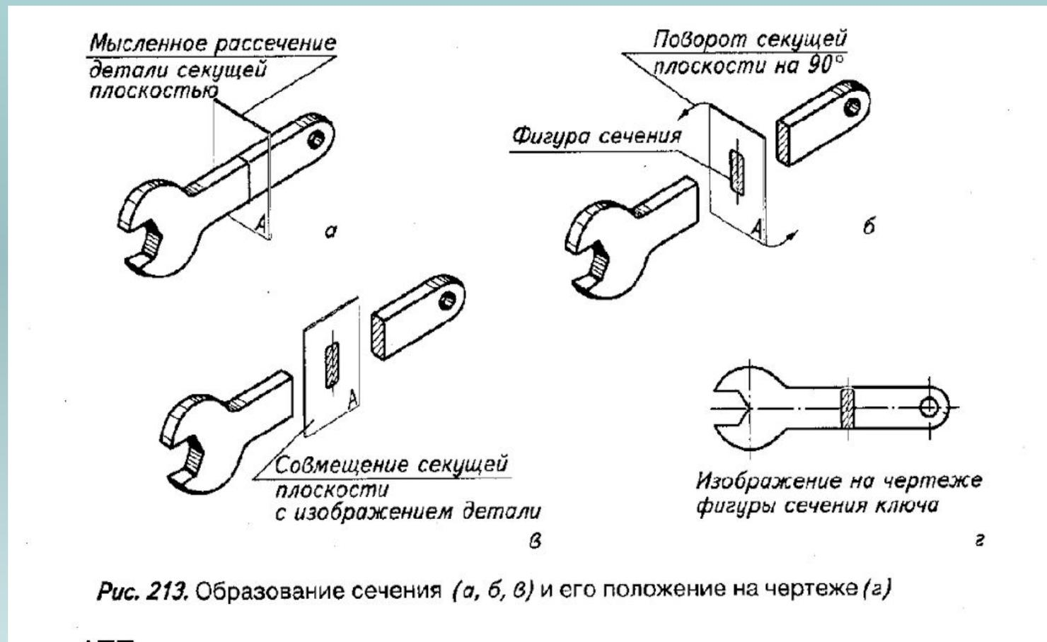
Контур сечения обозначают тонкими сплошными линиями. При этом контур детали в месте расположения сечения не прерывают.
