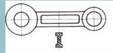
**Секущие плоскости проводятся перпендикулярно к направлению длины детали или к её оси, то есть фигура сечения раскрывает поперечное строение детали.**
