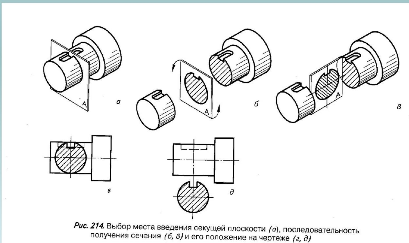
2. Вынесенное сечение расположено в разрыве, симметричное – линии сечений и стрелки не наносят
