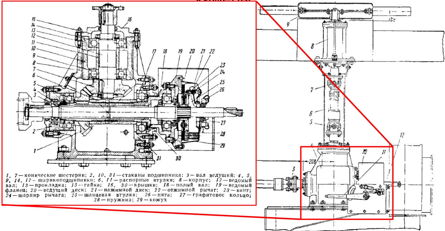
1, 3, 5, 7 — шарниры карданного вала; 2 — горизонтальный карданный вал; 4 — конический редуктор; 6 — вертикальный карданный вал; 8 — подшипник; 9 — колесо вентилятора; 10 — фрикционная муфта; 11 — рычаг отводки муфты; 12 — винт регулировки фрикционной муфты
