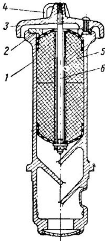
1 — корпус сапуна; 2 — диск; 3 — крышка; 4 — пружинный замок; 5 — фильтрующая набивка; 6 — стяжная шпилька
