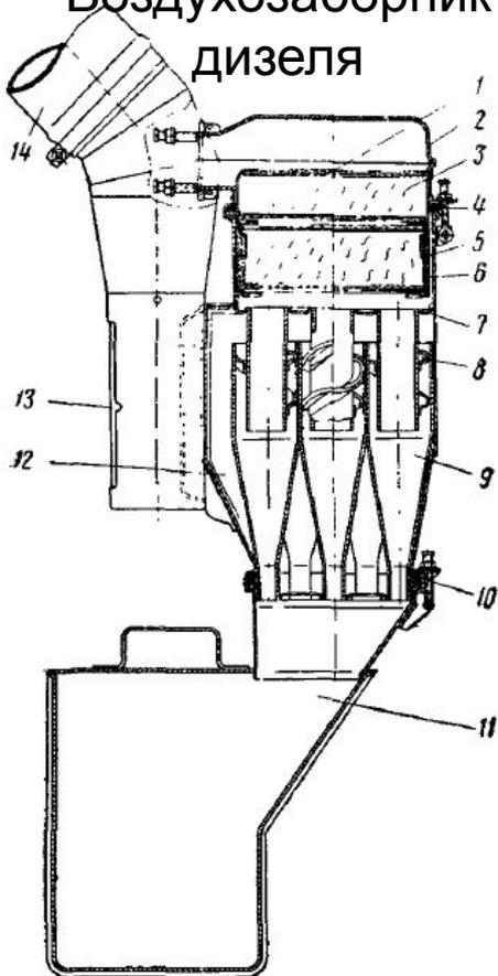
1 — сетка фильтра; 2 — головка воздухофильтра; 2 — кантель проволоочная; 4 — уплотнительное кольцо; 5 — патрон фильтра; 6 — кассета фильтра; 7 — корпус воздухофильтра; 8 — трубы со спиральными направляющими; 9 — пылесбрасывающие конусы; 10 — уплотнительное кольцо; 11 — бункер для пыли; 12 — окно для входа воздуха; 13 — заслонка; 14 — воздуховод
