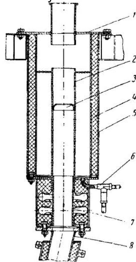
1 — корпус; 2 — выхлопная труба; 3 — диафрагма трубы; 4 — изоляция; 5 — кожух; 6 — спускная труба; 7 — вставка; 8 — патрубок
