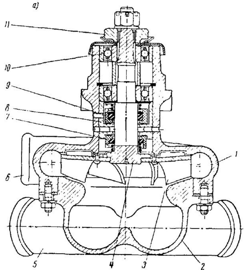
*a* — разрез; *б* — общий вид; 1 — корпус; 2 — крышка; 3 — крыльчатка; 4 — валик; 5 — приемные патрубки; 6 — отводящие патрубки; 7 — сальник; 8 — втулка; 9 — сальник; 10 — шарикоподшипник; 11 — муфта; 12 — корпус крана; 13 — клапан; 14 — пружина; 15 — кольцо
