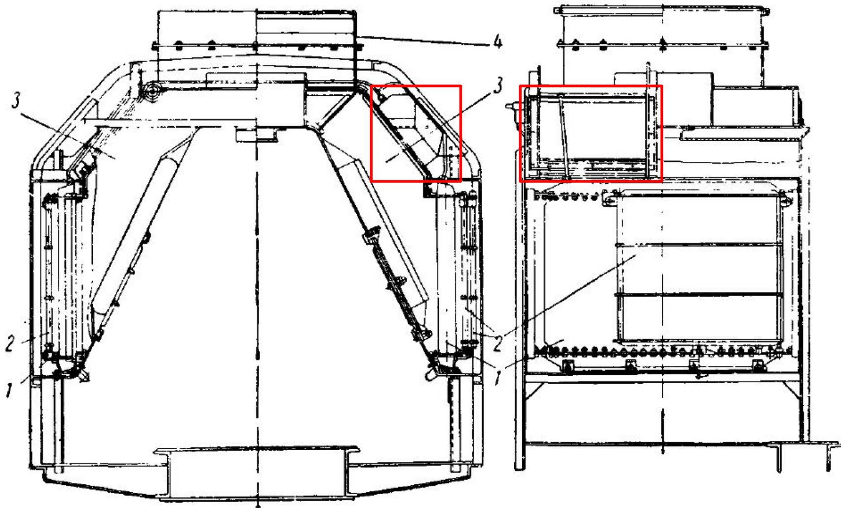
1 — водяной радиатор; 2 — масляный радиатор; 3 — шахта холодильника; 4 — диффузор вентиляционного колеса
