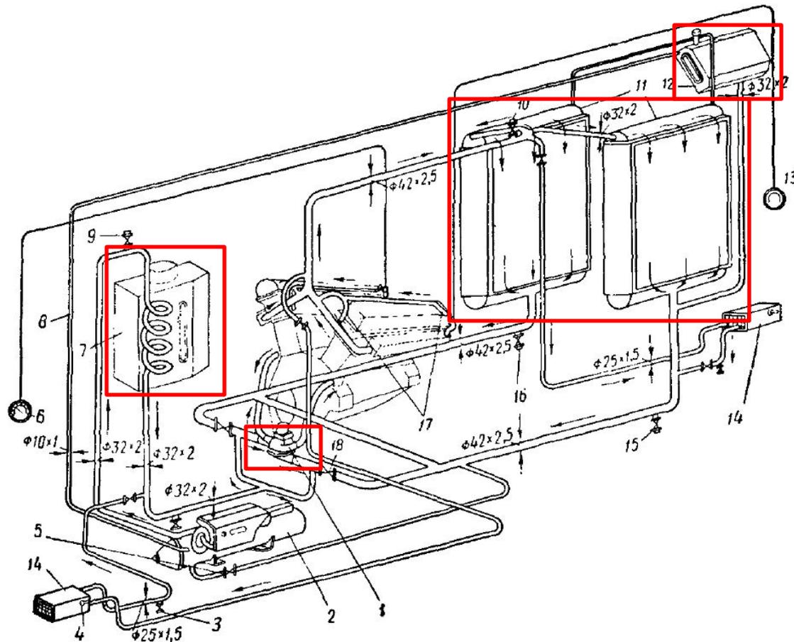
1 — водяной насос; 2 — котел-подогреватель; 3, 5 — вентили; 4 — воздухопускной кран; 6, 13 — манометрические термометры; 7 — масляный бак; 8 — паропроводная трубка; 9, 10 — воздухопускные краны; 11 — водяной радиатор; 12 — расширительный бак; 14 — калорифер; 15, 16 — спускные вентили; 17 — паропроводные трубки, двигателя; 18 — вентиль
