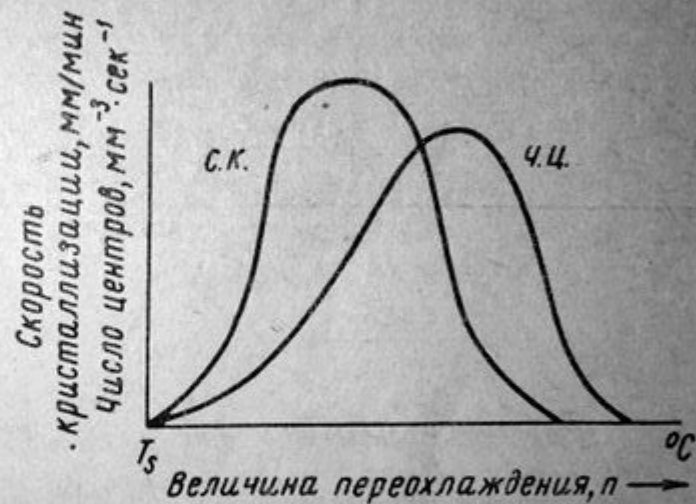
Рис. 25. Скорость роста кристаллов (с. к.) и скорость зарождения центров кристаллизации (ч. ц.) в зависимости от степени переохлаждения
