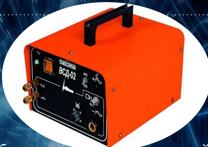
это устройство, преобразующее ток промышленной частоты низкого напряжения в ток высокой частоты (150-500 кГц) и высокого напряжения (2000-6000 В), наложение которого на сварочную цепь облегчает возбуждение и стабилизирует дугу при сварке, а также плавно снижает сварочный ток по окончании сварки
