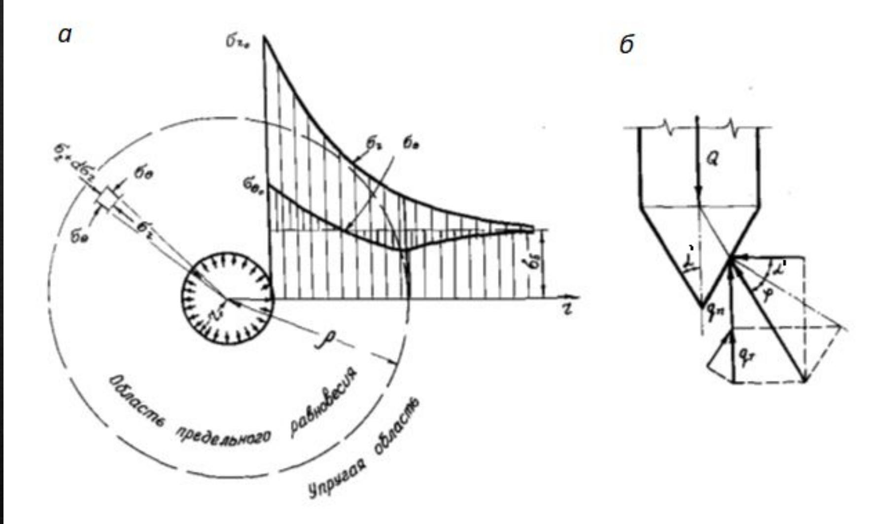
◆ Схема проникания зонда в упруго-пластическую среду:
