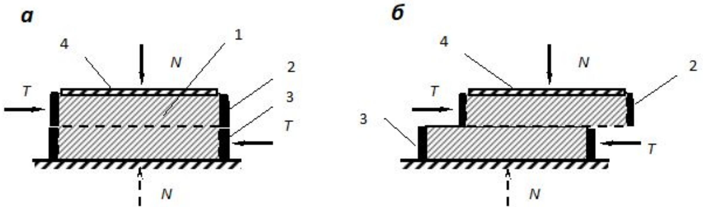
◆ **Схема испытания грунта на срез (сдвиг):**
