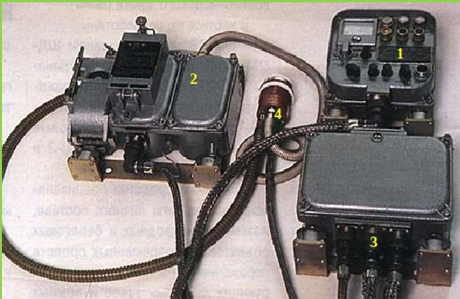
**Рис. 10. Прибор радиационной и химической разведки ПРХР.
