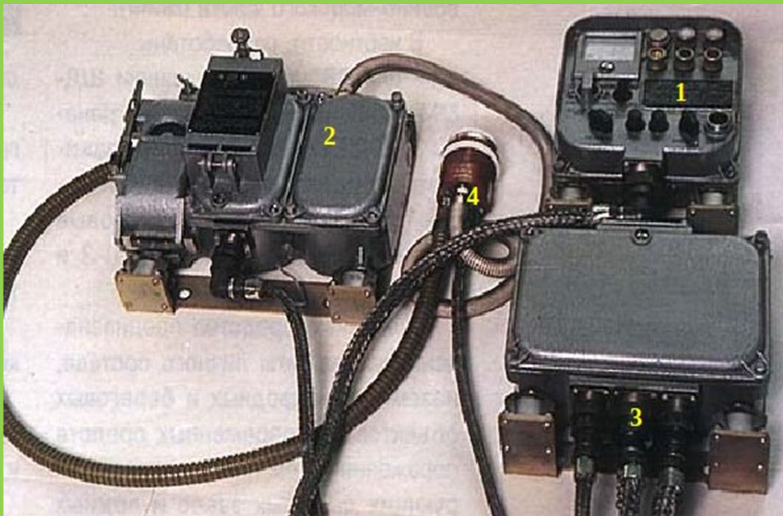
Рис. 10. Прибор радиационной и химической разведки ПРХР. 1-пульт измерительный; 2-датчик; 3-блок питания; 4-устройство для забора воздуха («циклон») с трубкой обогрева и выходной трубкой
