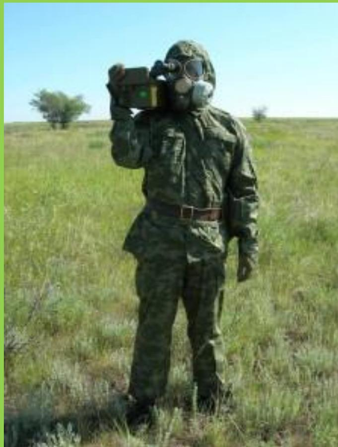
**Рис. 9. Малогабаритный общевойсковой прибор ПХРДД-3.
