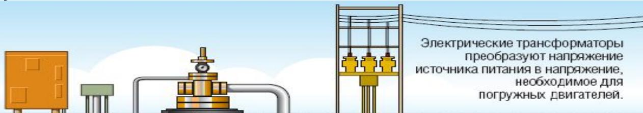
Электрические трансформаторы преобразуют напряжение источника питания в напряжение, необходимое для погружных двигателей.
