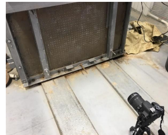
Рис.22 Фиксация деформаций методом фотограмметрии
