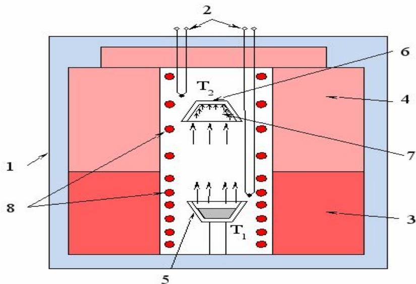
Рис. 6.10. Схематическое изображение процесса «выращивания» н.к. в градиентной печи.
