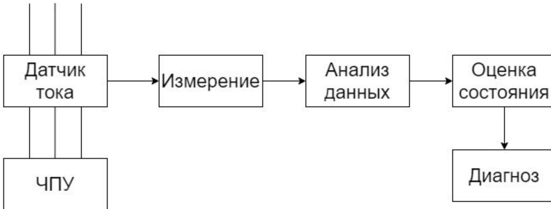
Структурная схема комплексной диагностической системы
