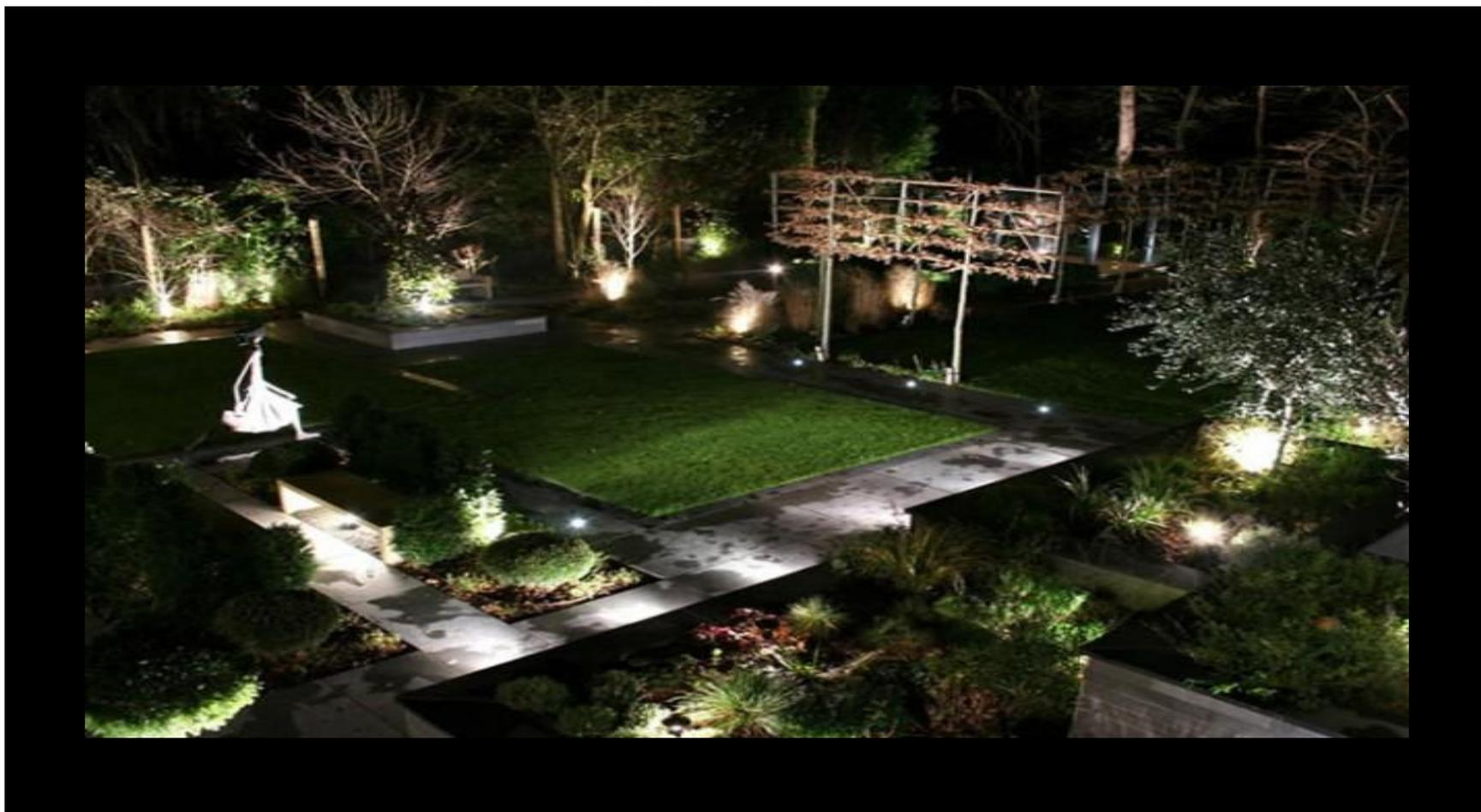
***Маркировочное освещение*** - оно скорее обозначает, нежели освещает. Более применимо для создания визуальных эффектов: обозначения направления движения и световых контуров или для выделения границы дорожек.
