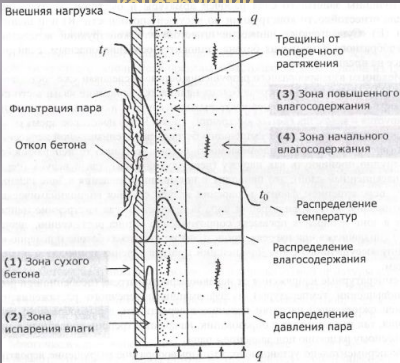
Рис. 1 – Механизм «взрывообразного» разрушения бетона.
