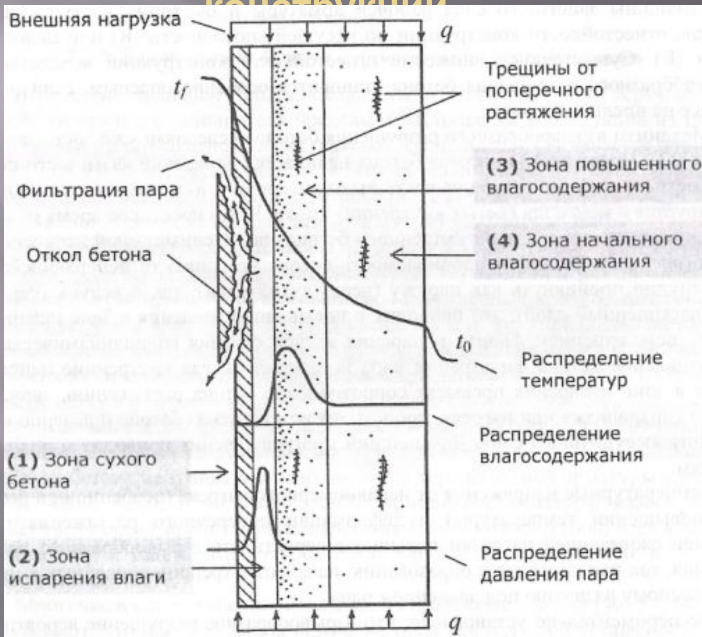
Рис. 1 – Механизм «взрывообразного» разрушения бетона.
