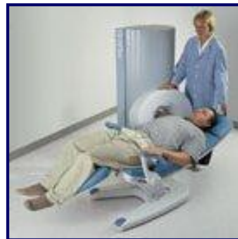
OrthOne (OrthOne) сверхпроводящий 1,0 Тл; 591 кг
