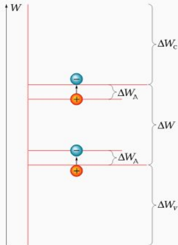
Рис. 4.3. Диаграмма зонной структуры: \Delta W_c — зона проводимости; \Delta W — запрещенная зона; \Delta W_v — валентная зона; W — энергия электрона; \Delta W_d — дополнительный энергетический уровень
