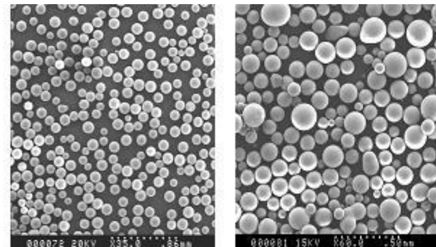
Порошок SiO<sub>2</sub>, сфероидизированный индукционной плазмой (воздушная плазма)
