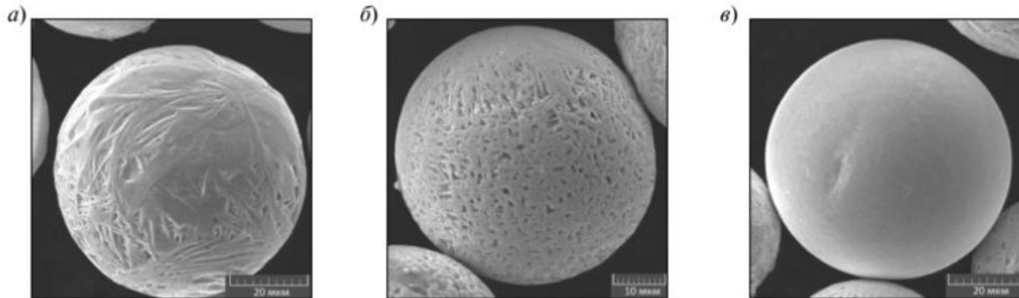
Морфология частиц порошка сплава Nb-16Si после плазменной сфероидизации на установке ИМЕТ РАН
