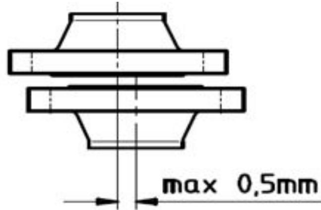
Расстояние между привалочными поверхностями фланцев = толщина прокладки + 1мм
