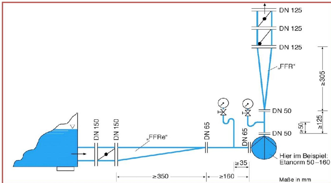
Пример насоса Etanorm 50 -160 (Q 80 м<sup>3</sup>/h).
