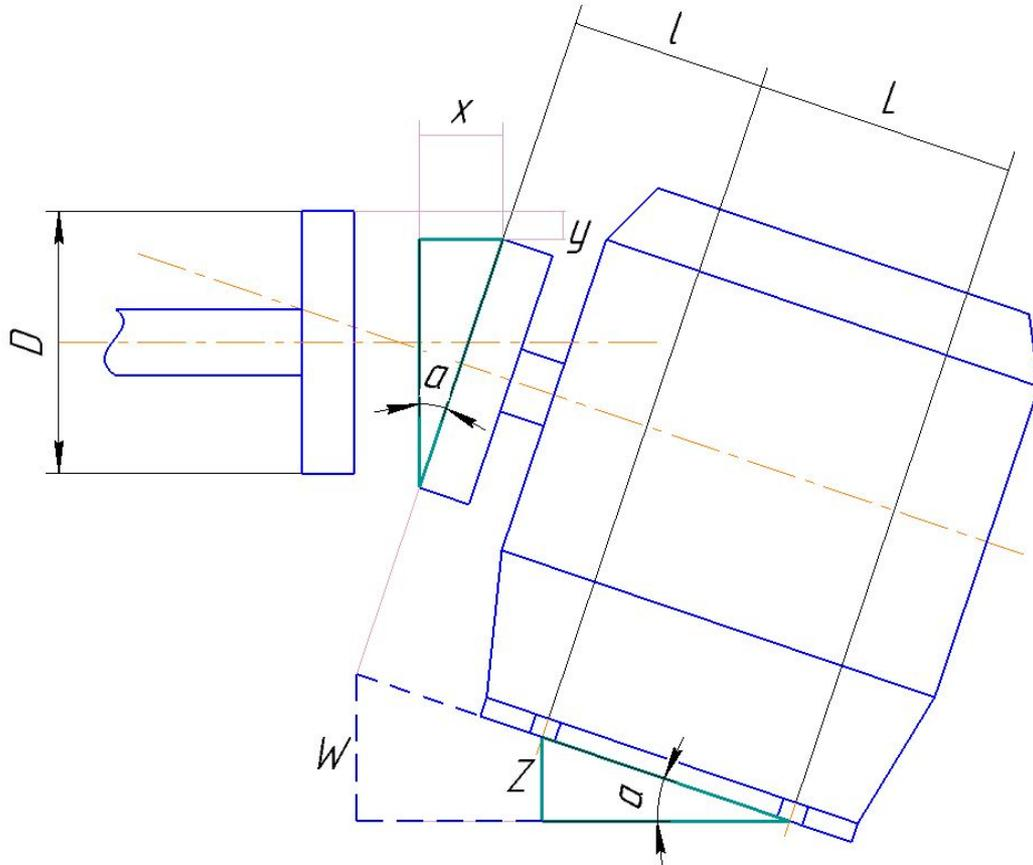
$x$  – «раскрытие» муфты = разность измерений зазора между п/муфтами в двух диаметрально-противоположных точках
