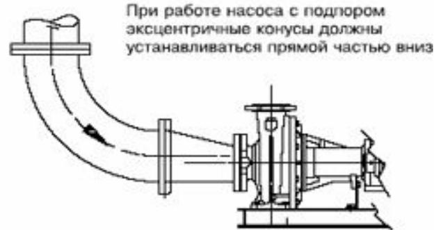
✓ Всасывающий/подводящий трубопровод к насосу прокладывается с уклоном вверх, а на подаче - с уклоном вниз.
