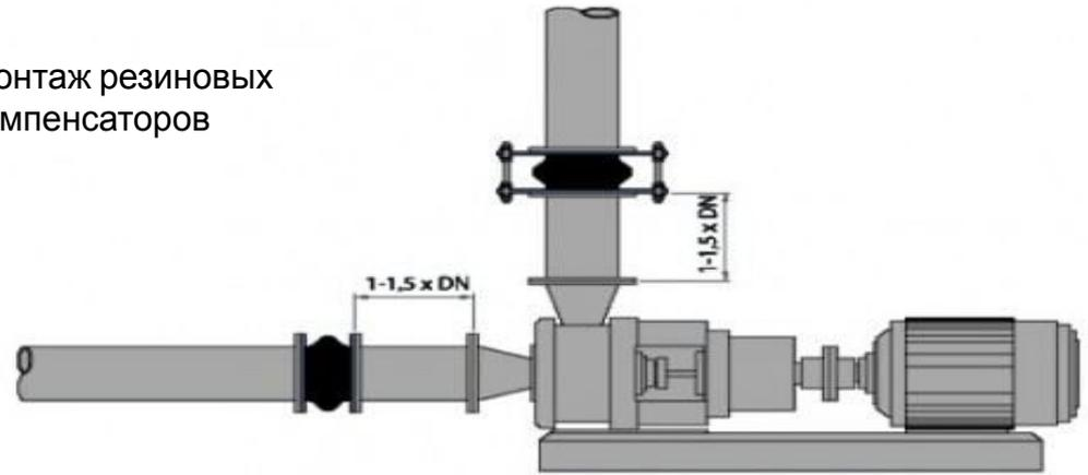
Установка сдвиговых резиновых компенсаторов для снижения поперечных (сдвиговых) перемещений.
