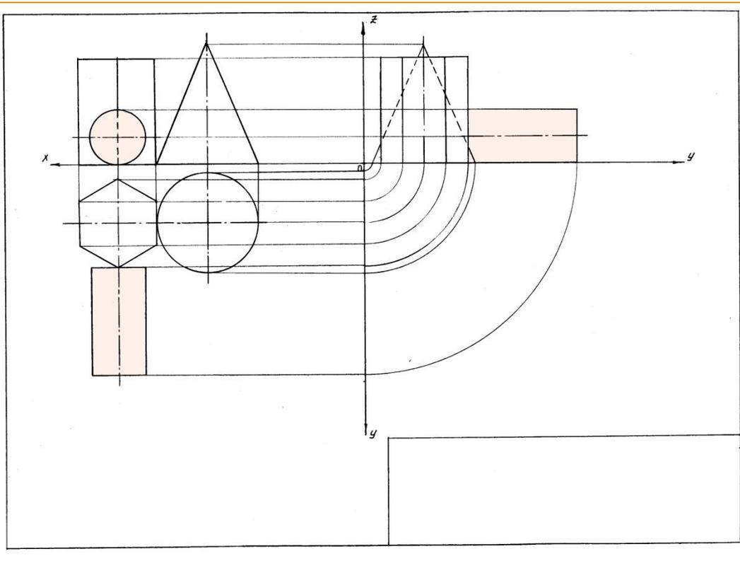
9. Начертить горизонтальную проекцию цилиндра
