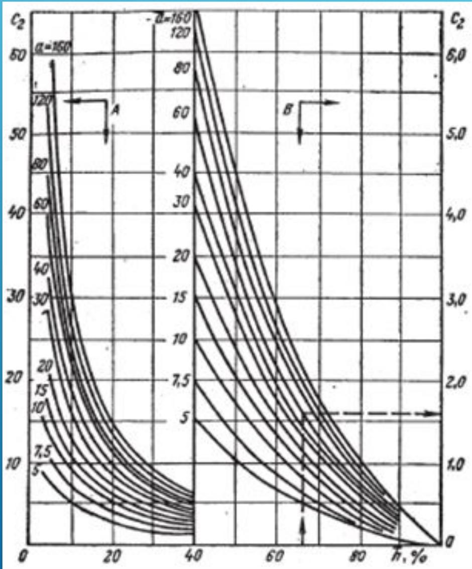
**Рисунок 3 – Зависимость коэффициента  $C_2$  от относительного вскрытия пласта  $h$  для различных значений  $a$  (по Щурову В.И.)**
