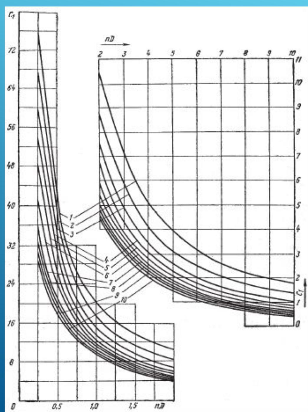
**Рисунок 2 – Зависимость коэффициента  $C_1$  от плотности перфорации ( $nD$ ) и относительного проникновения канала в пласт ( $l$ ) (по В.И. Щурову)**
