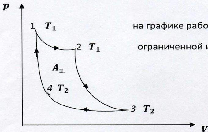
на графике работа газа за цикл  $A_{п.}$  – площадь фигуры, ограниченной изотермами и адиабатами.
