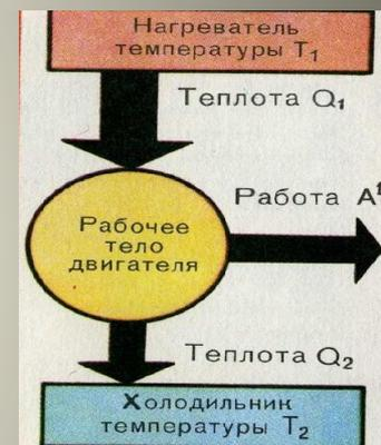
Французский инженер С.Карно, выясняя, при каком замкнутом процессе тепловой двигатель будет иметь максимальный КПД, предложил использовать цикл, состоящий из двух изотермических и двух адиабатных процессов (идеальная тепловая машина).
