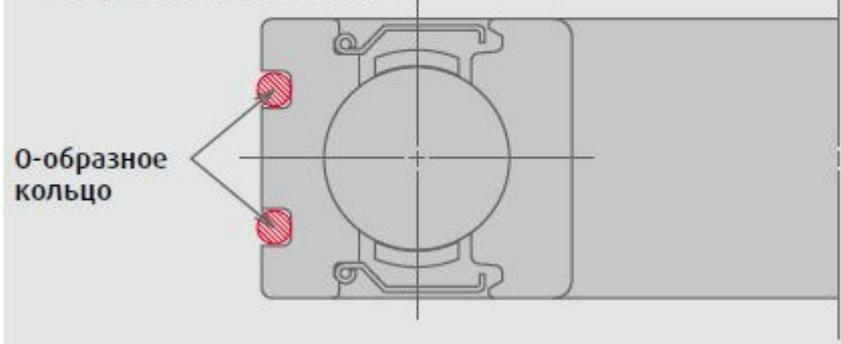
Испытания под нагрузкой момента проскальзывания (пример: 6204)
