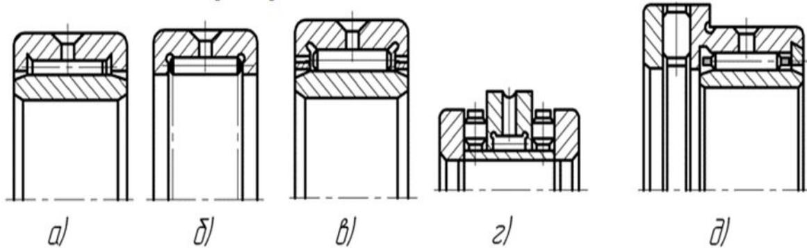
**Рис. 5.** Подшипники радиальные роликовые игольчатые или роликовые с длинными цилиндрическими роликами исполнения:
