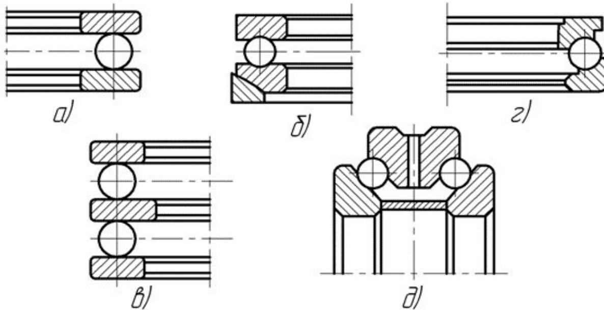
Рис. 8. Подшипники упорные и упорно-радиальные шариковые исполнений:
