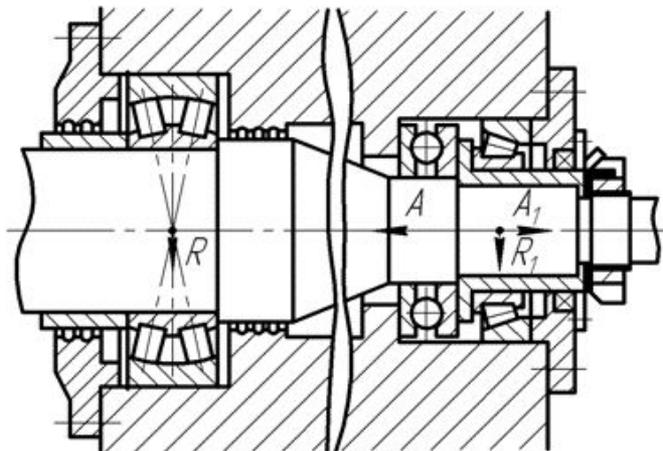
Комбинация конического роликоподшипника с упорным шарикоподшипником, воспринимающим значительные осевые нагрузки одностороннего направления при небольших частотах вращения. Конический роликоподшипник может воспринимать кроме значительных радиальных небольшие осевые нагрузки противоположного направления. Зазоры в обоих подшипниках выбираются при помощи торцевой крышки и набора регулировочных прокладок между крышкой и корпусом
