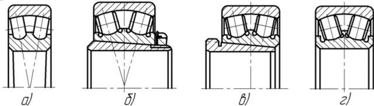
**Рис. 4. Подшипники радиальные роликовые сферические исполнений:**
