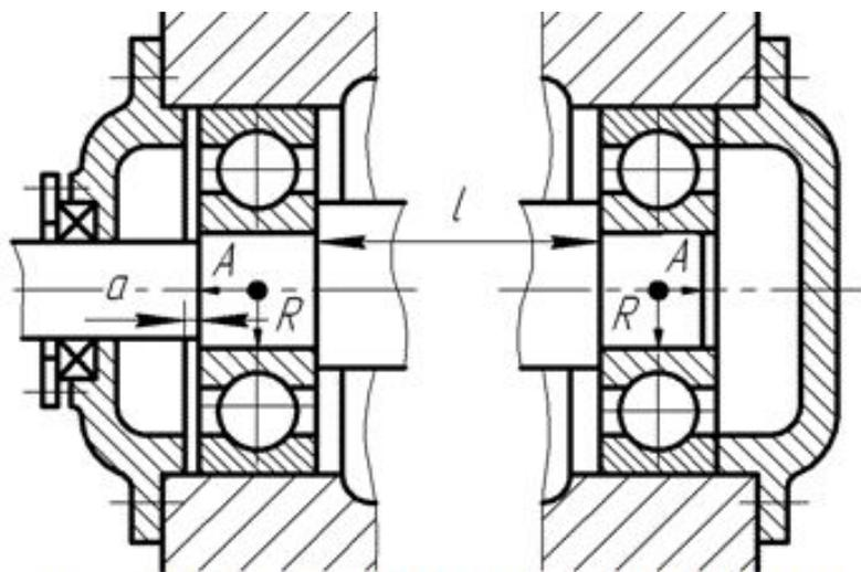
Радиальные шарикоподшипники в общей сквозной расточке корпусов. Зазор  $a \approx 12 \times 10^{-6} t l + 0,15$  мм, где  $t$  - максимальный возможный перепад температуры вала, °С
