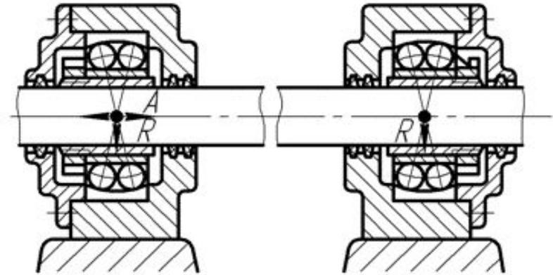
Сферические шарикоподшипники в отдельных корпусах на длинных и гладких вала устанавливаемые на закрепительных втулках. Допустимы значительные прогибы вала от радиальных нагрузок, а также несоосность посадочных мест подшипников
