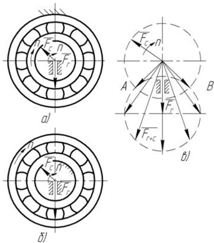
Случаи местного нагружения внутреннего кольца при циркуляционном нагружении наружного кольца (а), циркуляционного нагружения внутреннего кольца при местном нагружении наружного (б) и круговая диаграмма изменения равнодействующей силы при (в)
