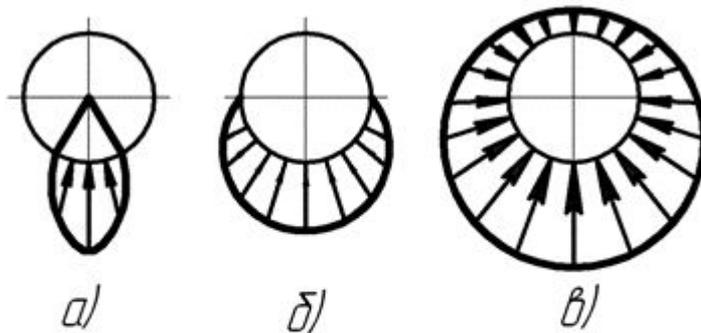
Рис. 1. Распределение нагрузок на тела качения
