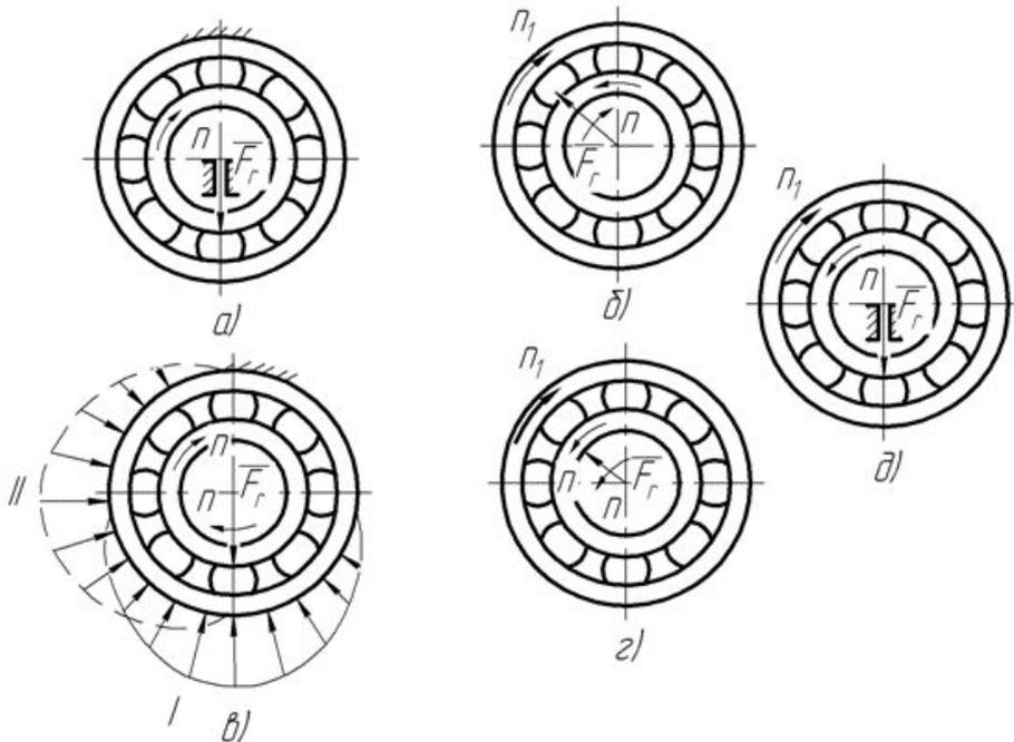
Случаи циркуляционного нагружения внутреннего кольца (а, б), наружного кольца (в, г), обоих колец (д)
