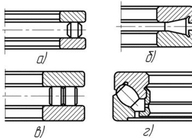
Рис. 9. Подшипники упорные и упорно-радиальные роликовые исполнений:
