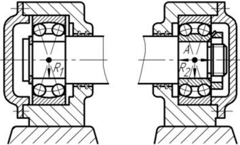
Сферические шарикоподшипники, допускающие несоосность посадочных мест в прогиб вала, в отдельных корпусах
