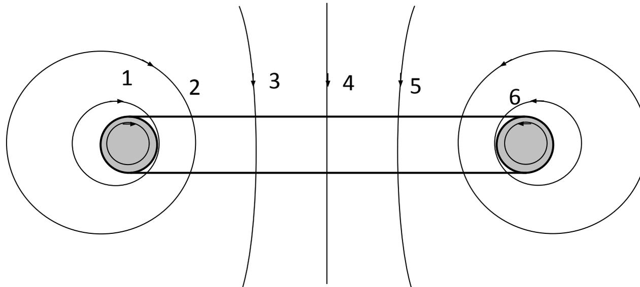
Часть трубок магнитного потока (1 – 6), сцепленных с витком, не проходит сквозь проводник с током, а поток, созданный этими трубками называется **внешним магнитным потоком**. Трубки магнитного потока, проходящие сквозь материал проводника, сцепляются только с частью тока в проводнике и создают магнитный поток, называемый **внутренним магнитным потоком**.
