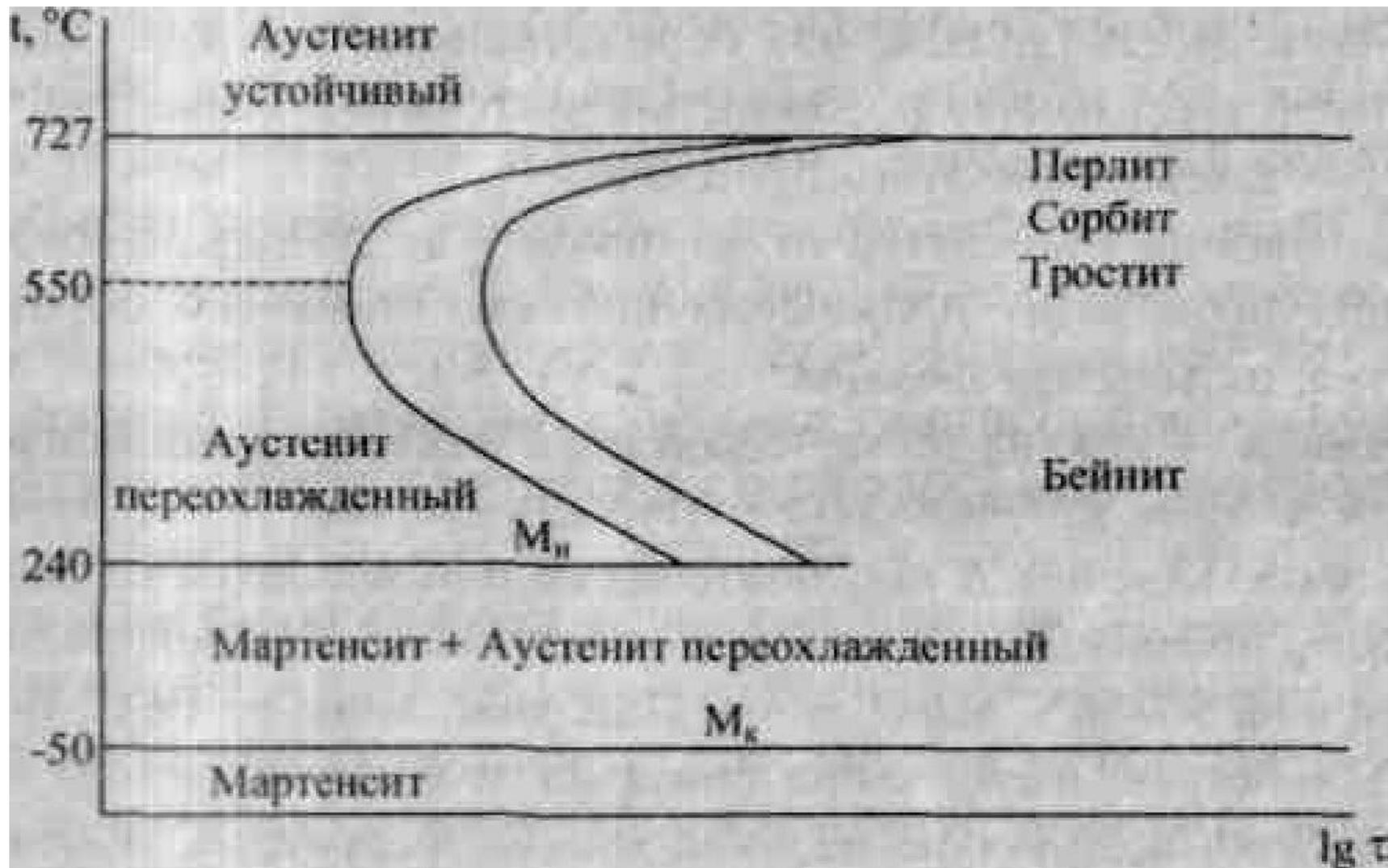
**Рис 16. Диаграмма изотермического превращения аустенита эвтектоидной стали (схема).**
