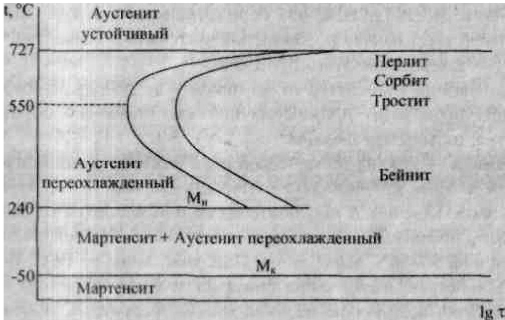
Рис 16. Диаграмма изотермического превращения аустенита эвтектоидной стали (схема).
