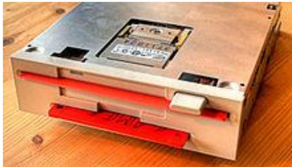
Это устройство использует в качестве носителя информации гибкие магнитные диски – дискеты, которые могут быть 5-ти или 3-х дюймовыми.
