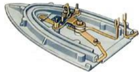
СХЕМА ЭЛЕКТРИЧЕСКОЙ ЦЕПИ УТЮГА
