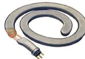
СХЕМА СОЕДИНЕНИЯ СПИРАЛЕЙ В ТРУБЧАТОМ НАГРЕВАТЕЛЬНОМ ЭЛЕМЕНТЕ
