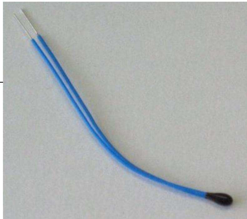
Термопара - два провода из разных металлов, спаянных в одной точке. Для измерения разности температур удобно использовать дифференциальную термопару: две одинаковых термопары, соединенных навстречу друг другу. у термопар очень много преимуществ: имеют очень большой температурный диапазон от  $-200^{\circ}\text{C}$  до  $1800-2200^{\circ}\text{C}$ , они просты в использовании и недорогие.
