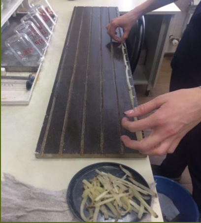
Качество стружки. Определение длины стружки и выявление брака
