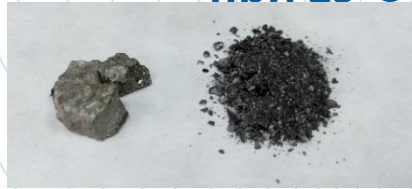
Рис. 10 – Лигатура Nd-Fe до и после гидрирования
