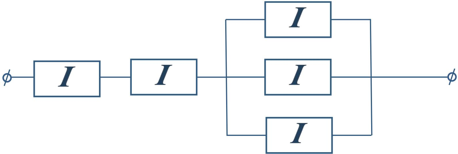
На рисунке изображена схема смешанного соединения проводников, сопротивления которых следующие:  $R_1=3$  Ом,  $R_2=4$  Ом,  $R_3=5$  Ом,  $R_4=10$  Ом,  $R_5=5$  Ом. Определить общее сопротивление на участке цепи.
