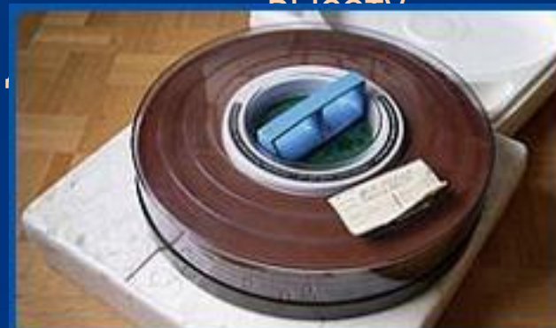
IBM 1316: накопитель со сменными носителями
