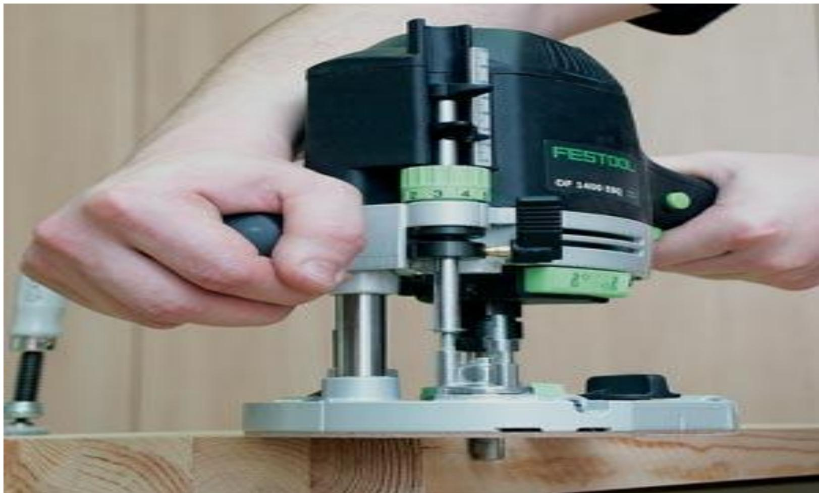
При опускании «головы» фреза войдет в заготовку на глубину, выставленную на откалиброванной шкале
