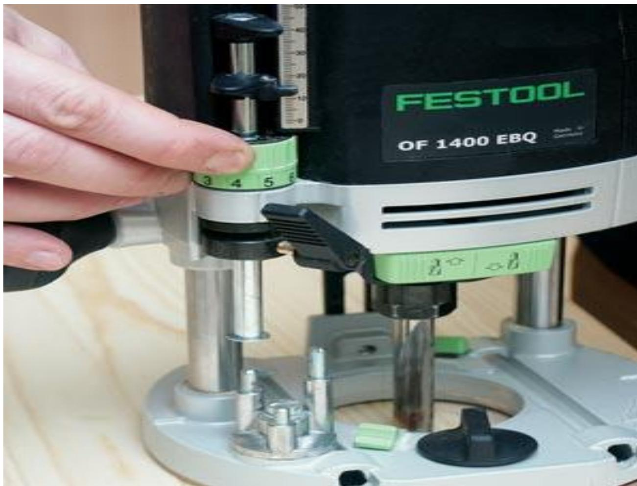
Если операция требует точности, хороший фрезер позволяет скорректировать установленное значение глубины
