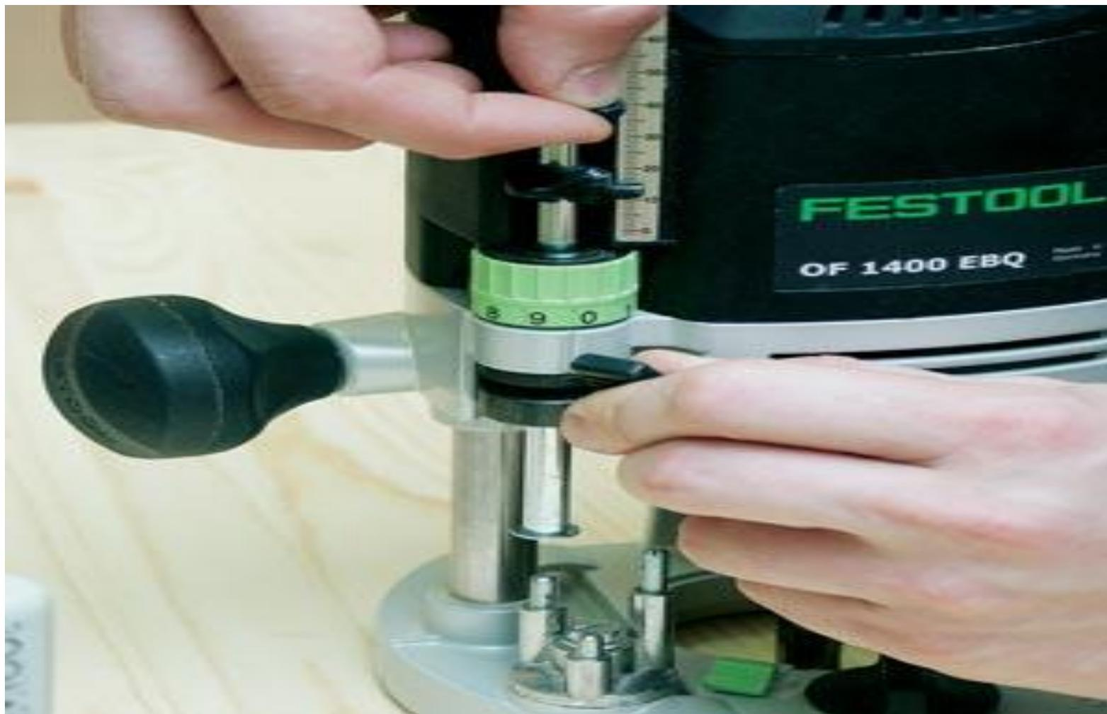
Штангу поднимают до совпадения указателя с требуемым делением измерительной шкалы и зажимают ее фиксатором
