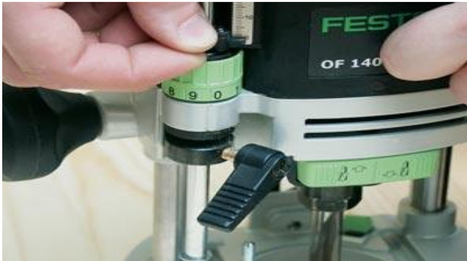
Голову» инструмента опускают до упора фрезой в поверхность, после чего ее удобно фиксировать. Далее, исходя из вылета режущей оснастки и желаемой глубины обработки, выбирают самую низкую из подходящих «ножек» револьверного упора
