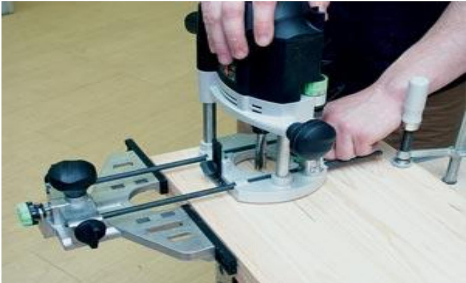
Фрезер устанавливают на линию разметки, упор подводят к кромке и фиксируют. В данном случае обе штанги зажимают вращением одной рукоятки, обычно — несколькими «персональными» винтами
