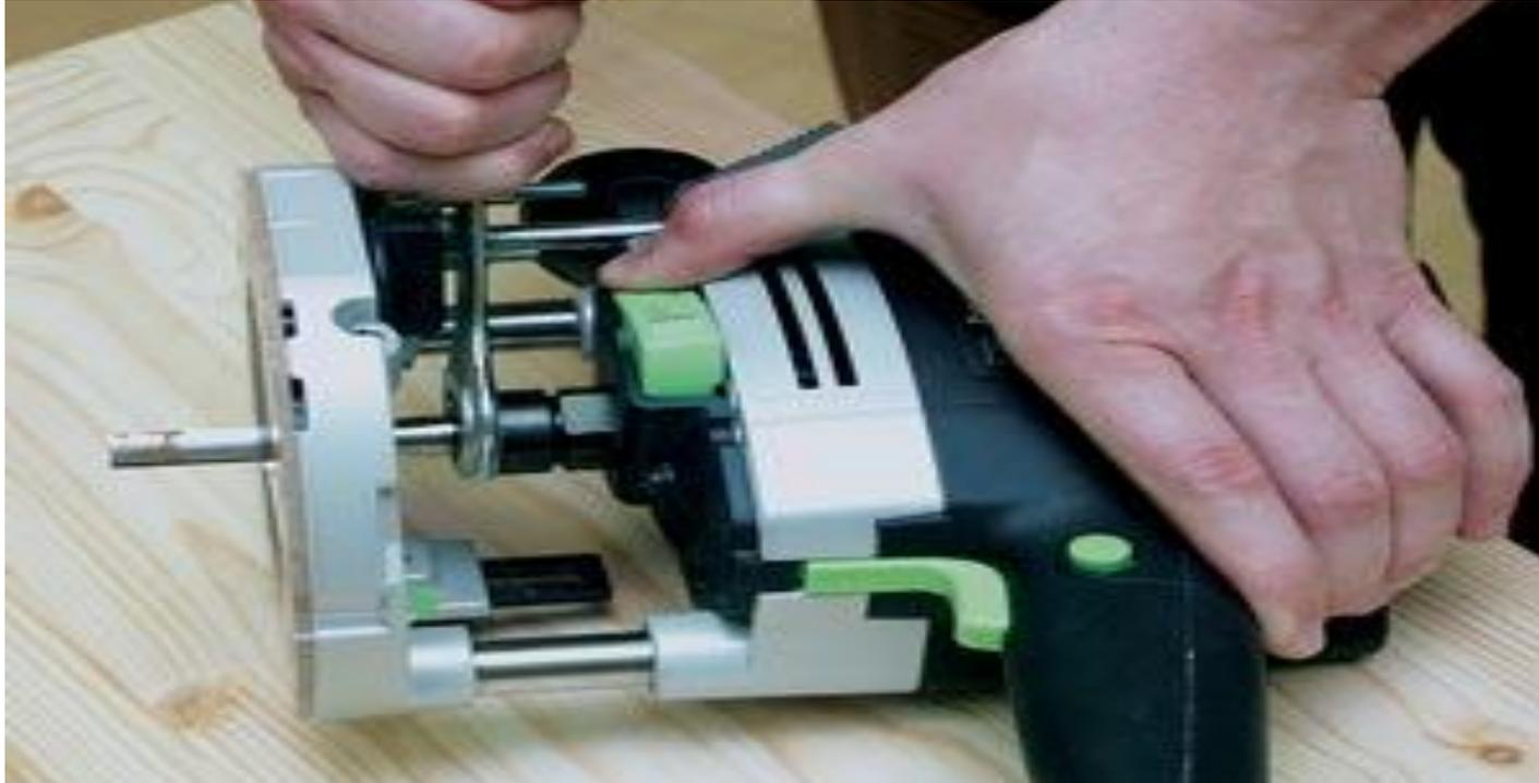
Фрезу зажимают в цангу, пользуясь рожковым ключом и механизмом блокировки вала. Если последнего не предусмотрено, понадобится второй ключ
