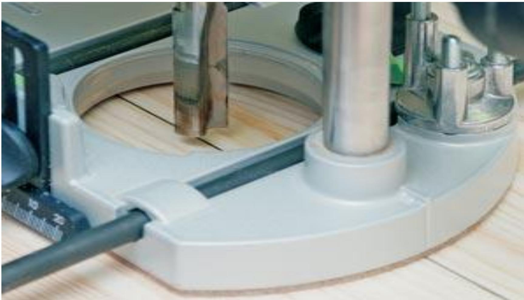
Точная настройка позволяет добиться полного совпадения линии разметки и оси фрезы. Для облегчения процедуры на подошве делают «мушку-прицел», по которой легче ориентироваться.
