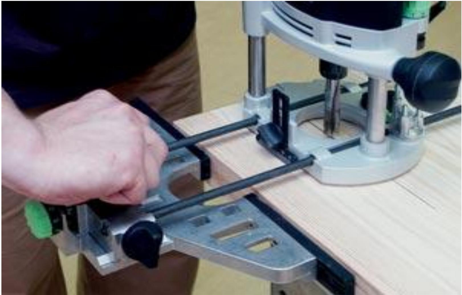
После окончания настройки механизм фиксируют
