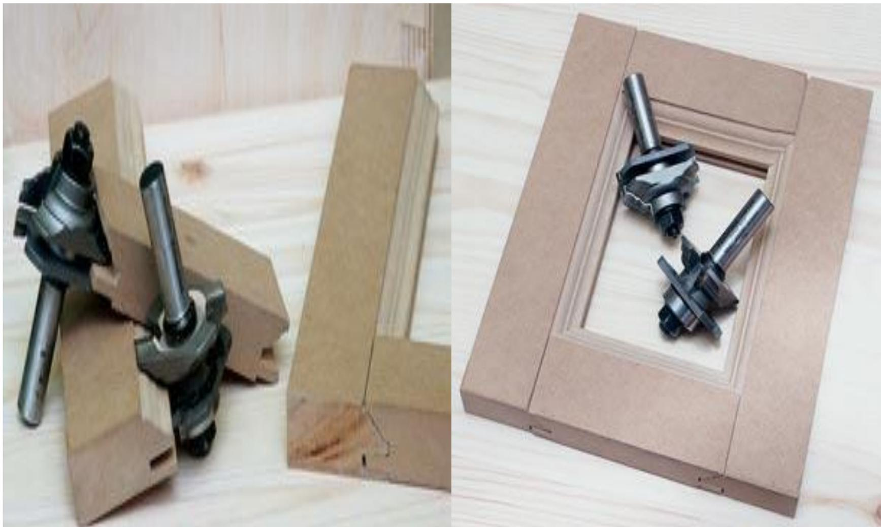
Такая оснастка удобна в работе и к тому же позволяет фрезеровать криволинейные кромки
