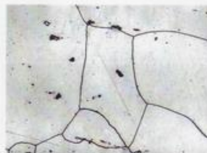
Микроструктура стали 37X12H8Г8МФБ
