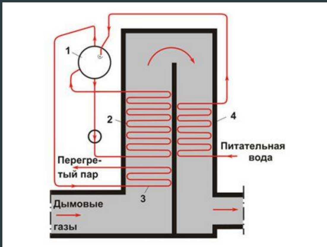
Схема котла-утилизатора с принудительной циркуляцией: 1 — барабан; 2 — испарительная часть; 3 — пароперегреватель; 4 — водяной экономайзер.
