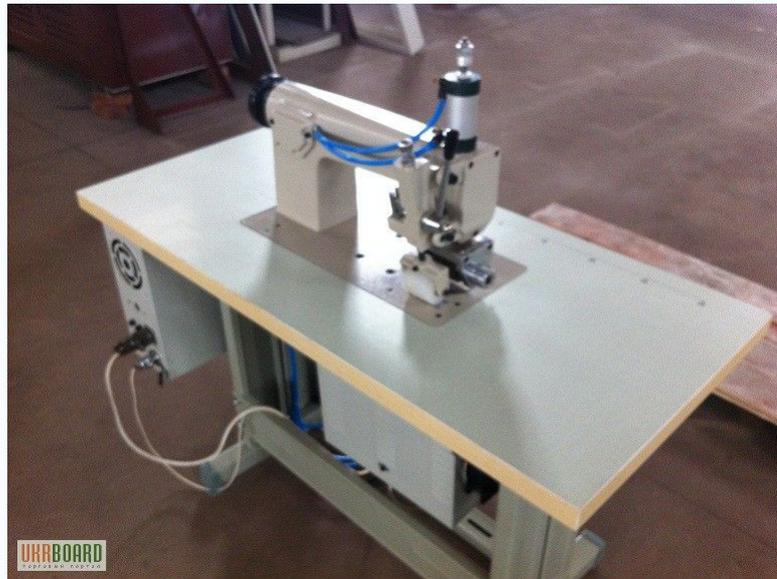
Установка для ультразвуковой сварки текстильных материалов состоит из акустического узла, верхней опоры и ультразвукового генератора (УЗГ). Акустическим узлом является электромеханический преобразователь, который преобразует электрические колебания ультразвуковой частоты, получаемые в ультразвуковом генераторе, в акустические (механические) колебания такой же частоты.
