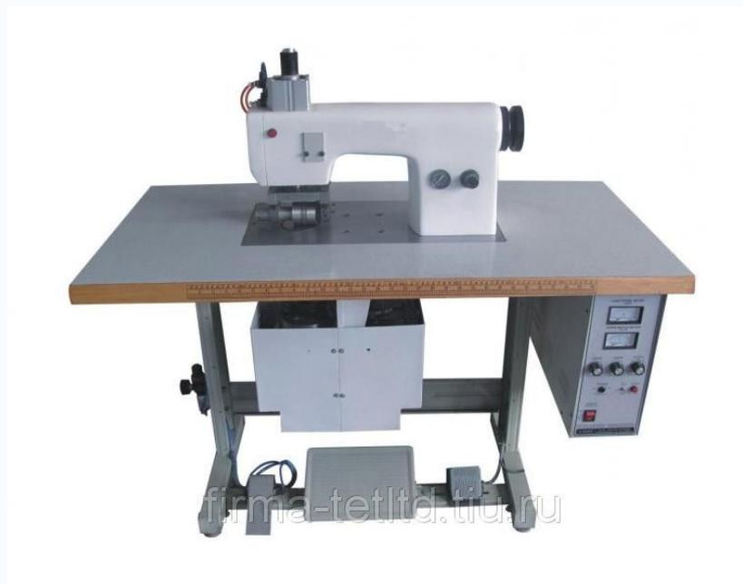
Безниточная швейная машина – это машина, соединяющая детали одежды пунктирным или непрерывным швом любой конфигурации путём расплавления материала в месте контакта под действием ультразвуковых колебаний. Применяется в промышленности для изготовления изделий из синтетических материалов, соединения натуральных тканей с синтетическими, а также искусственной кожи с синтетическими плёнками.
