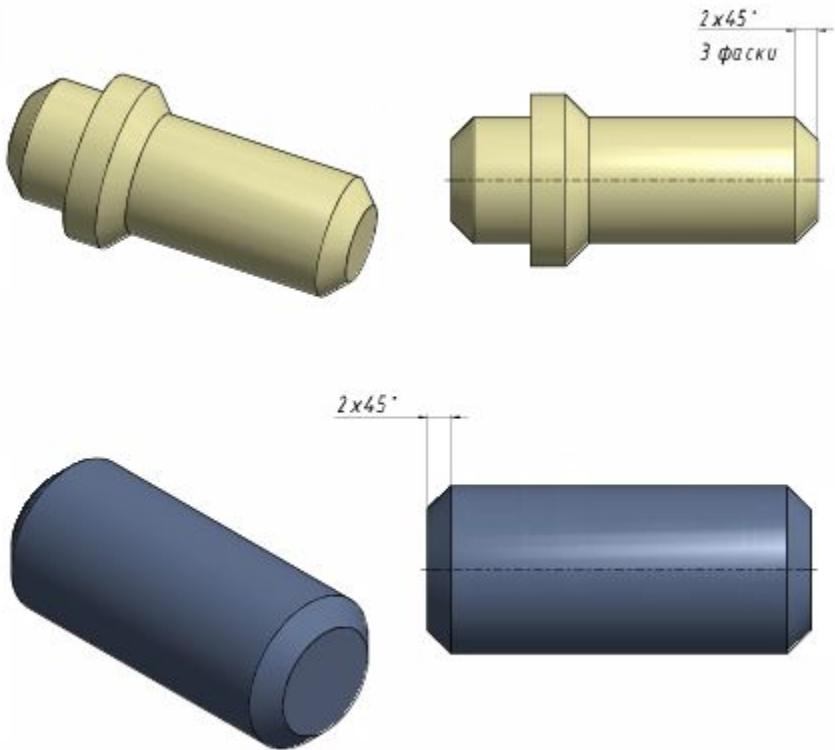
Если деталь имеет несколько одинаковых фасок на поверхностях вращения разных диаметров, то размер фаски наносят только один раз, указывая число фасок
