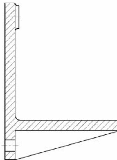
Бобышки (приливы) у литых деталей облегчают обработку опорных поверхностей под головки болтов, шайбы, гайки
