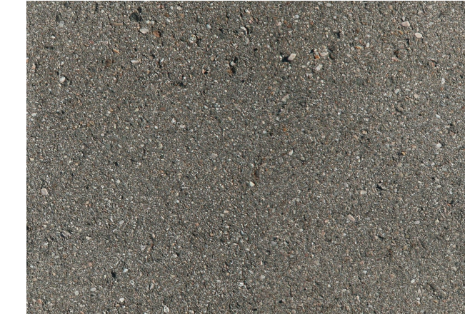
Асфальтобетон– Четыре седьмых Фракция 0-5 мм
