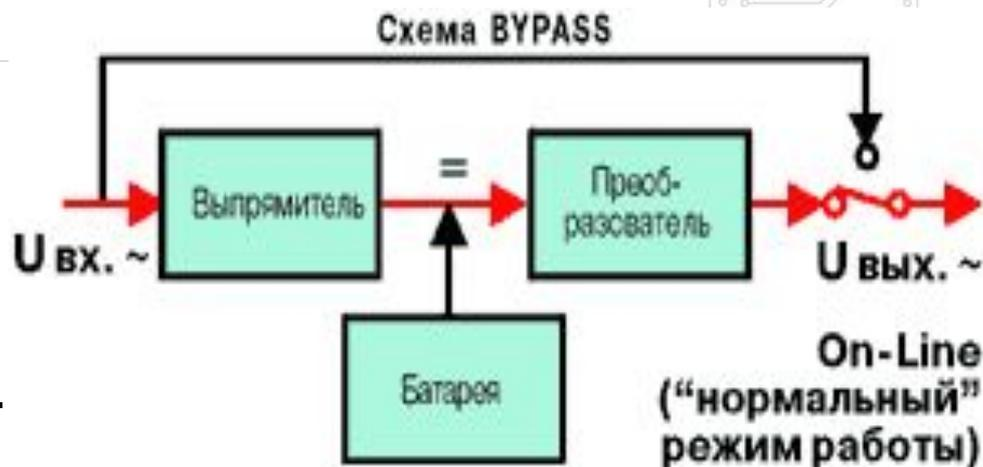
(+) идеальное питание нагрузки при любых неполадках в сети, нулевое время перехода на АБ без переходных процессов. Питание нагрузки без перехода на АБ в широком диапазоне напряжения сети (160 ... 276 В)
