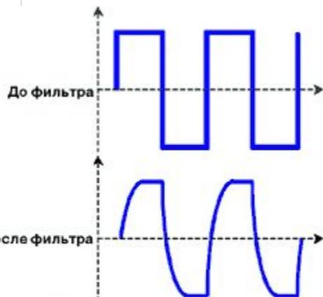
Форма напряжения на выходе инвертора, генерирующего прямоугольные импульсы
