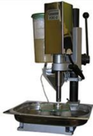
Станок ультразвуковой прошивки отверстий разных форм УЗС
