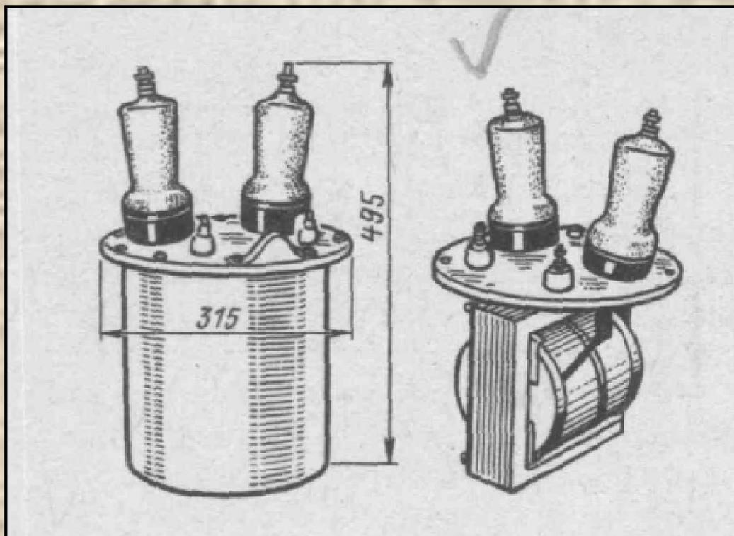
Он имеет значительные размеры и массу: его высота составляет 495 мм и масса 36 кг. По мере повышения напряжения размеры, масса и стоимость трансформаторов такой конструкции быстро увеличиваются. Чтобы устранить эти недостатки, необходимо изменить конструкцию трансформатора.
