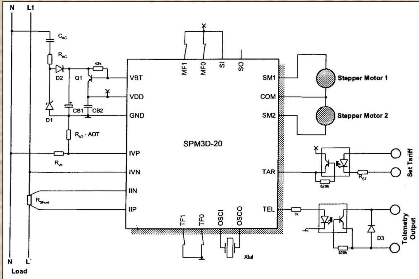
Схема подключения SPM3D для однофазного счетчика электроэнергии
