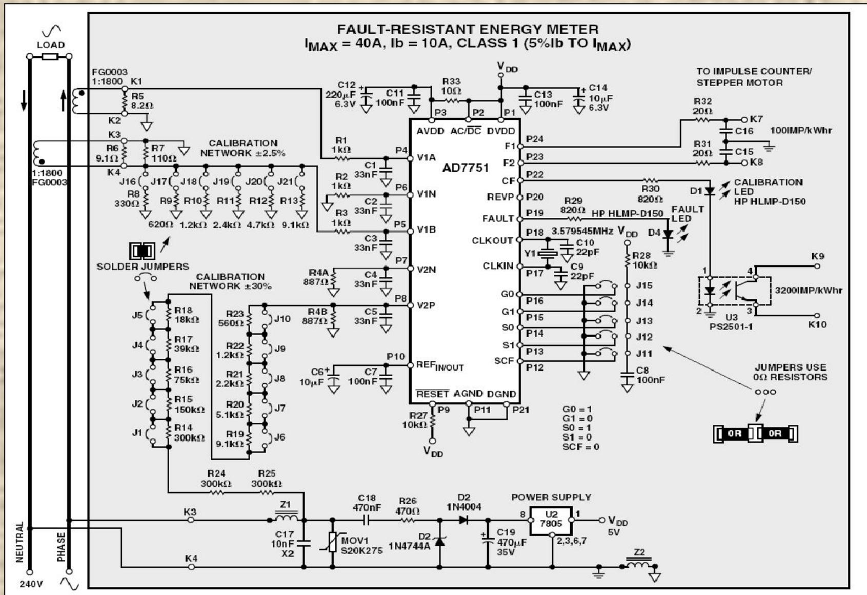
Схема простого однофазного счетчика электроэнергии на основе AD7751
