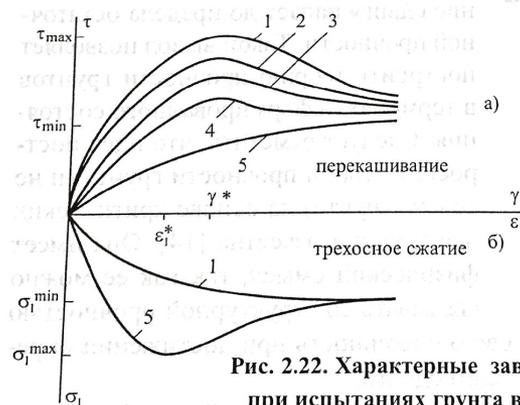
**Рис. 2.22. Характерные зависимости  $\tau-\gamma$  (а) и  $\epsilon_1-\sigma_1$  (б) при испытаниях грунта в кинематическом режиме нагружения с различной фиксированной скоростью:**
