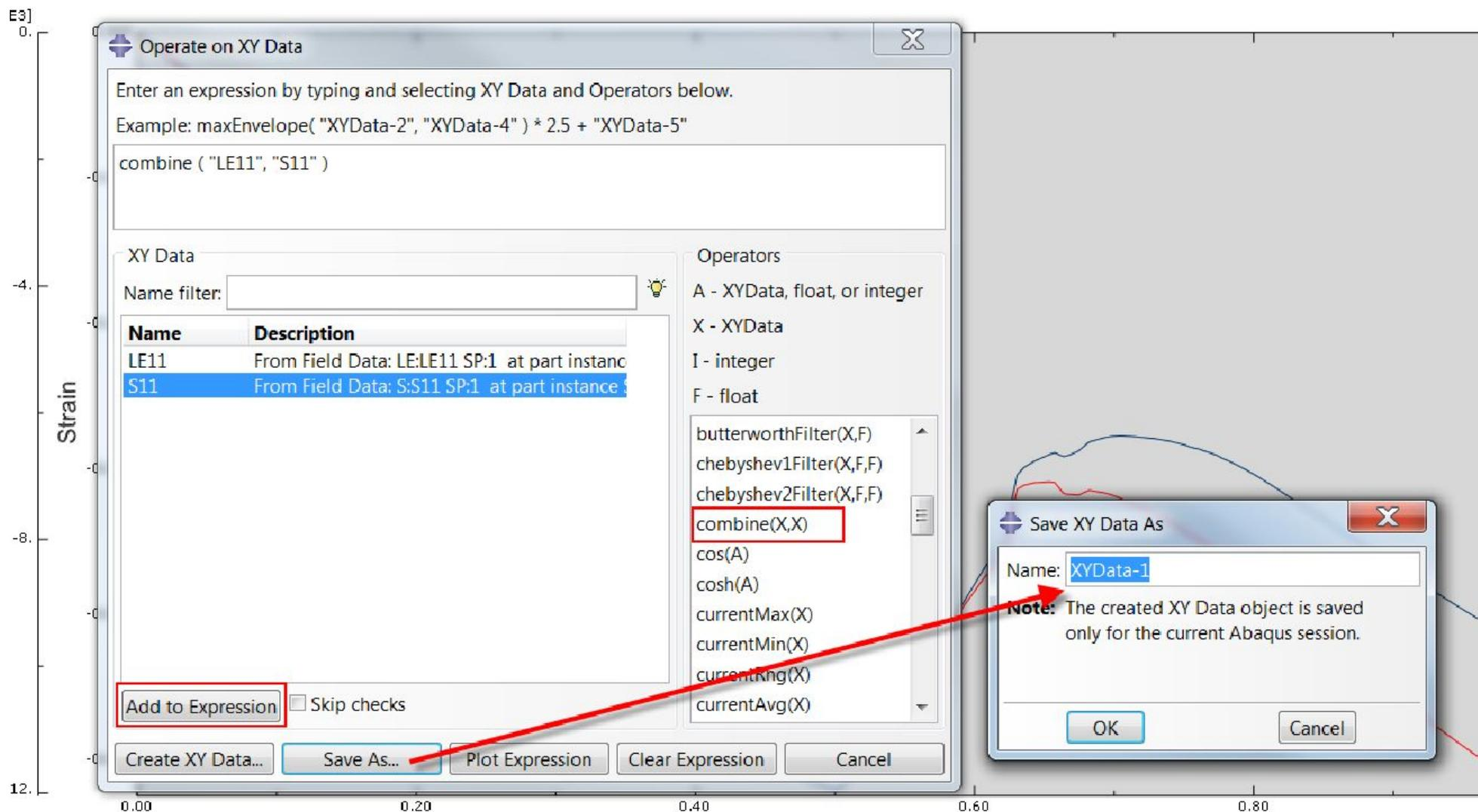
Теперь, построение графика XYData-1 даст вам график Strain vs Stress <Напряжение-Деформация>.
