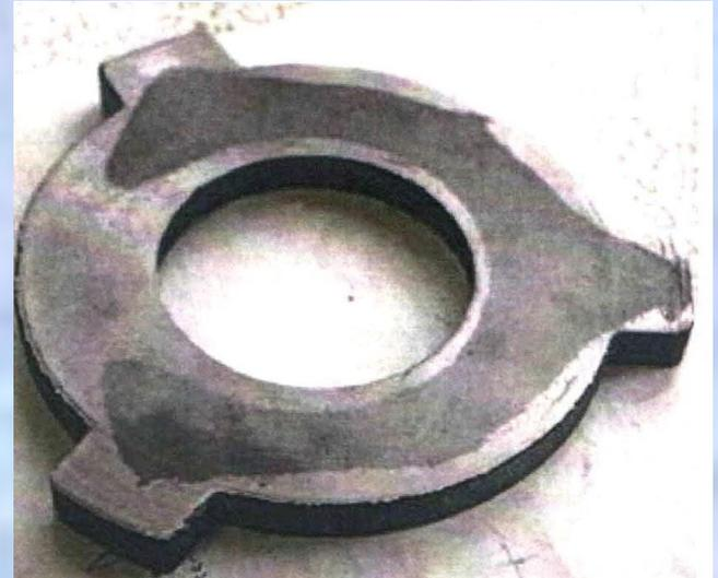
**2. Половинчатость (отсер, половинчатый графит) – дефект в виде проявления структуры серого чугуна в отливках из белого чугуна**
