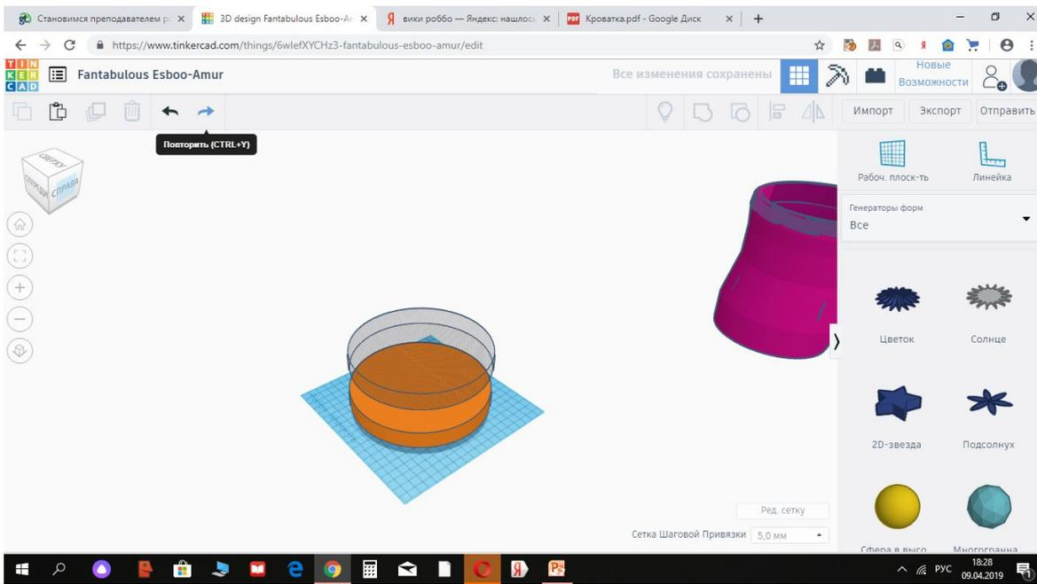
Далее делаем полую крышку и с помощью спиралевидного многоугольника формируем резьбу в крышке
