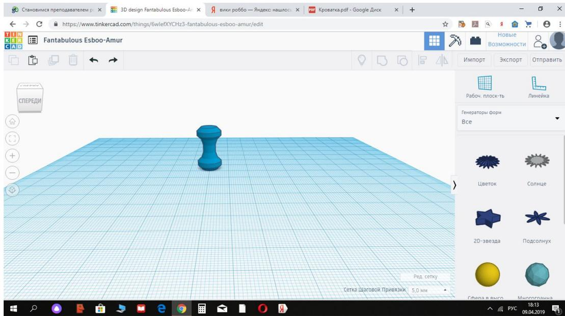
Для изготовления модели 3D – «Поильник» взяли исходную фигуру Цилиндр с несколькими радиусами (рис. 1) и придали ей форму детского поильника (рис.2).
