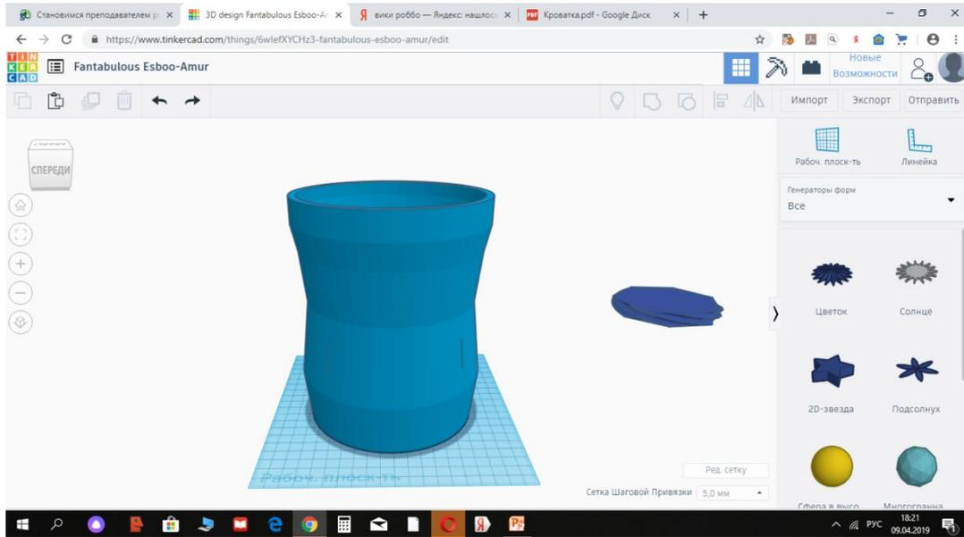
Для формирования резьбы использовалась фигура спиралевидный многоугольник, предварительно придав ему подходящую форму
